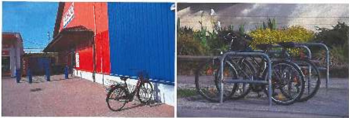
52. ábra: Elavult, csak a kerék rögzítésére alkalmas / korszerű kerékpártámaszok
